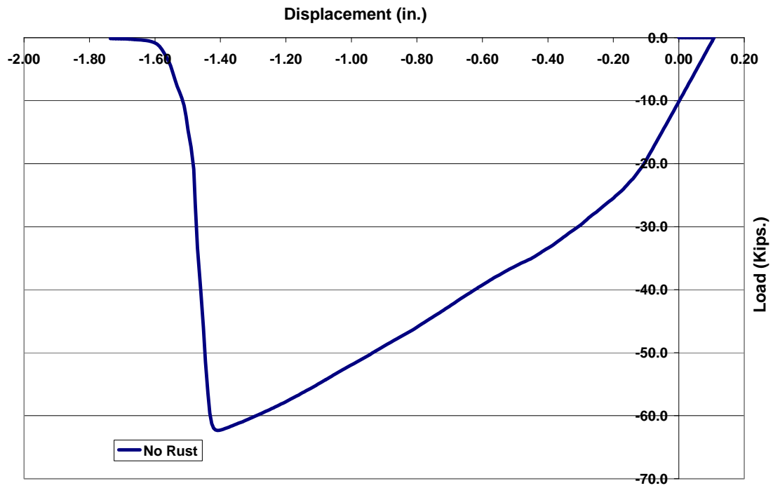
Fig. 4 Load Deflection Predicted by ELS
